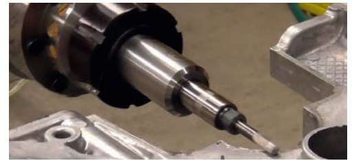
Ejemplo de aplicación: Desbarbado de piezas de fundición
