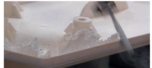
Ejemplo de aplicación: Desbarbado de materiales compuestos de fibra
