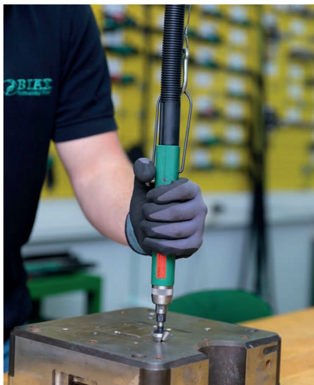
Todos los avellanadores rectos pueden ser utilizados con un equilibrador de muelle.
