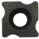
Biseladora para trabajos de biselado en todo tipo de aceros con radio 3. Las dos plaquitas de cuatro cortes proporcionan un buen acabado de una forma rápida y rentable. El cambio de plaquita se realiza con una sencilla operación. Permite biselados interiores y exteriores siempre que se disponga de un diámetro mínimo de 22 mm y de un espesor superior a 5 mm.
