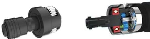
**IMPACTO.** Para tornillos de tamaño medio y grande, donde no sea necesario un control del par, siendo ideales para montajes y desmontajes rápidos y potentes. Requiere experiencia por parte del operario para no realizar aprietes con exceso de par. Par máximo en función de la presión de aire, existiendo modelos con regulador del caudal de aire incorporado.
