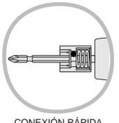
CONEXIÓN RÁPIDA PARA LA PUNTA
