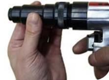
1. Desmontar la carcasa delantera, la cual habitualmente es de rosca a izquierdas (para aflojar girar a derechas) y liberar el sistema de embrague.
