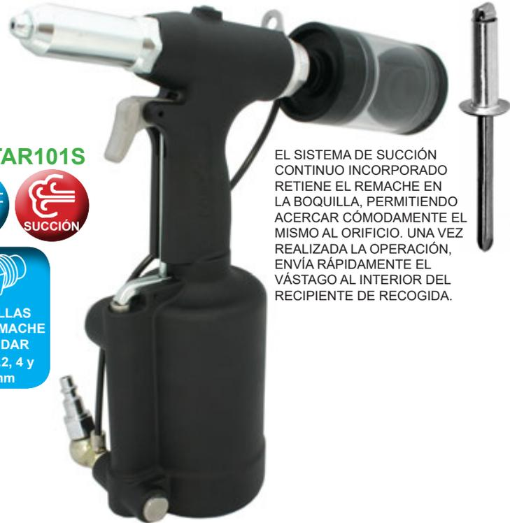
EL SISTEMA DE SUCCIÓN CONTINUO INCORPORADO RETIENE EL REMACHE EN LA BOQUILLA, PERMITIENDO ACERCAR CÓMODAMENTE EL MISMO AL ORIFICIO. UNA VEZ REALIZADA LA OPERACIÓN, ENVÍA RÁPIDAMENTE EL VÁSTAGO AL INTERIOR DEL RECIPIENTE DE RECOGIDA.
