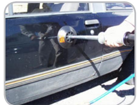
Especificaciones obtenidas a una presión de aire constante de 6,2 bar. Manguera recomendada de Ø interior de 8 mm
