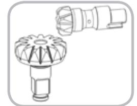
SISTEMA DE TRANSMISIÓN MEDIANTE PIÑÓN Y CORONA
