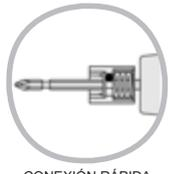
CONEXIÓN RÁPIDA PARA LA PUNTA
