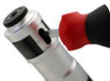
1. Retirar, girando o con un desplazamiento hacia delante o detrás (según modelo) la protección de la ventana de regulación. Mirando por la ventana ranurada, gire el eje de la máquina hasta localizar el orificio de la tuerca interior.
