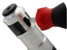
La regulación de par se realiza de la misma manera indicada en el embrague deslizante
