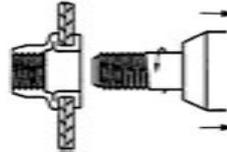
5. INTRODUCIR EL TORNILLO PARA REALIZAR LA UNIÓN DE LAS CHAPAS
