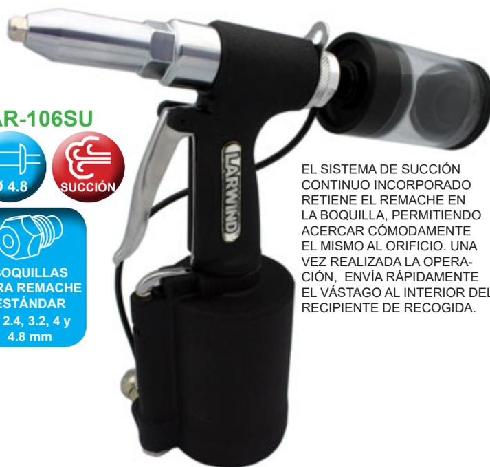
EL SISTEMA DE SUCCIÓN CONTINUO INCORPORADO RETIENE EL REMACHE EN LA BOQUILLA, PERMITIENDO ACERCAR CÓMODAMENTE EL MISMO AL ORIFICIO. UNA VEZ REALIZADA LA OPERACIÓN, ENVÍA RÁPIDAMENTE EL VÁSTAGO AL INTERIOR DEL RECIPIENTE DE RECOGIDA.
