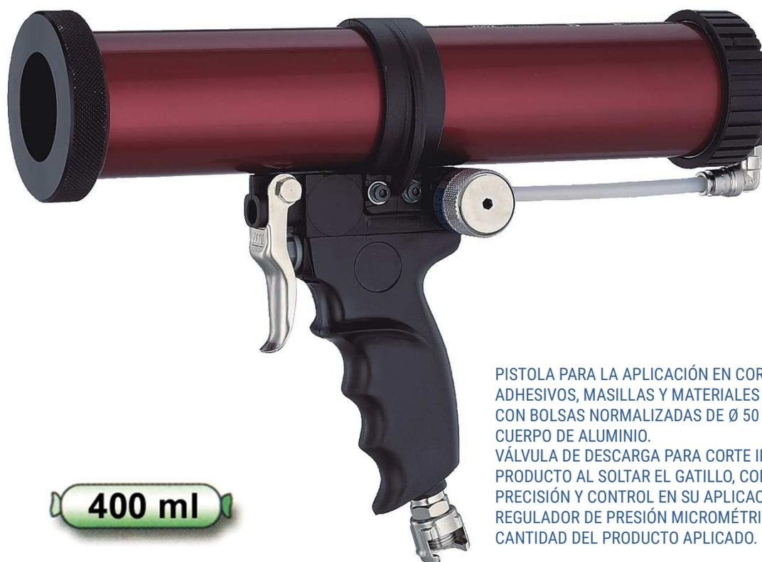
PISTOLA PARA LA APLICACIÓN EN CORDÓN DE SELLANTES, ADHESIVOS, MASILLAS Y MATERIALES DE BAJA Y MEDIA DENSIDAD CON BOLSAS NORMALIZADAS DE Ø 50 mm HASTA 400 ml. CUERPO DE ALUMINIO. VÁLVULA DE DESCARGA PARA CORTE INMEDIATO DE SALIDA DE PRODUCTO AL SOLTAR EL GATILLO, CONSIGUIENDO UNA MAYOR PRECISIÓN Y CONTROL EN SU APLICACIÓN. REGULADOR DE PRESIÓN MICROMÉTRICO PARA CONTROLAR LA CANTIDAD DEL PRODUCTO APLICADO.
