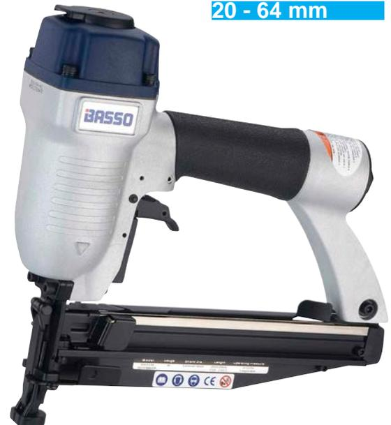
Presión de aire de 6 a 7 Kg/cm<sup>2</sup>. Manguera de Ø interior de 8 mm. Rosca entrada de 1/4
