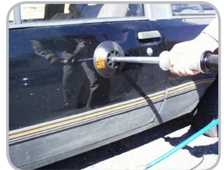
Especificaciones obtenidas a una presión de aire constante de 6,2 bar. Manguera recomendada de Ø interior de 8 mm
