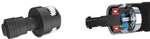
**IMPACTO.** Para tornillos de tamaño medio y grande, donde no sea necesario un control del par, siendo ideales para montajes y desmontajes rápidos y potentes. Requiere experiencia por parte del operario para no realizar aprietes con exceso de par. Par máximo en función de la presión de aire, existiendo modelos con regulador del caudal de aire incorporado.
