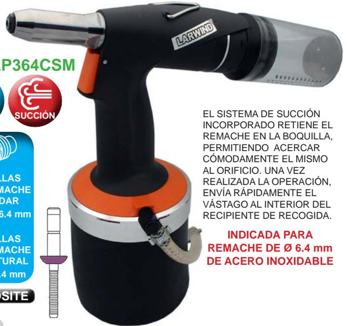
EL SISTEMA DE SUCCIÓN INCORPORADO RETIENE EL REMACHE EN LA BOQUILLA, PERMITIENDO ACERCAR CÓMODAMENTE EL MISMO AL ORIFICIO. UNA VEZ REALIZADA LA OPERACIÓN, ENVÍA RÁPIDAMENTE EL VÁSTAGO AL INTERIOR DEL RECIPIENTE DE RECOGIDA.
