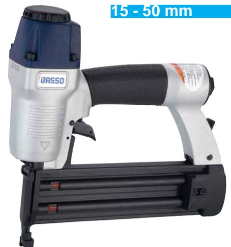
Presión de aire de 6 a 7 Kg/cm<sup>2</sup>. Manguera de Ø interior de 8 mm. Rosca entrada de 1/4
