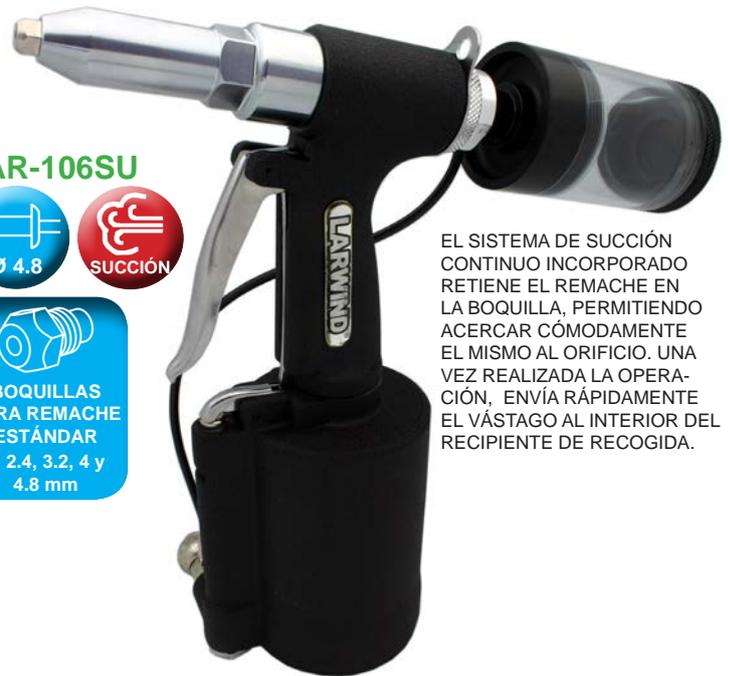
EL SISTEMA DE SUCCIÓN CONTINUO INCORPORADO RETIENE EL REMACHE EN LA BOQUILLA, PERMITIENDO ACERCAR CÓMODAMENTE EL MISMO AL ORIFICIO. UNA VEZ REALIZADA LA OPERACIÓN, ENVÍA RÁPIDAMENTE EL VÁSTAGO AL INTERIOR DEL RECIPIENTE DE RECOGIDA.
