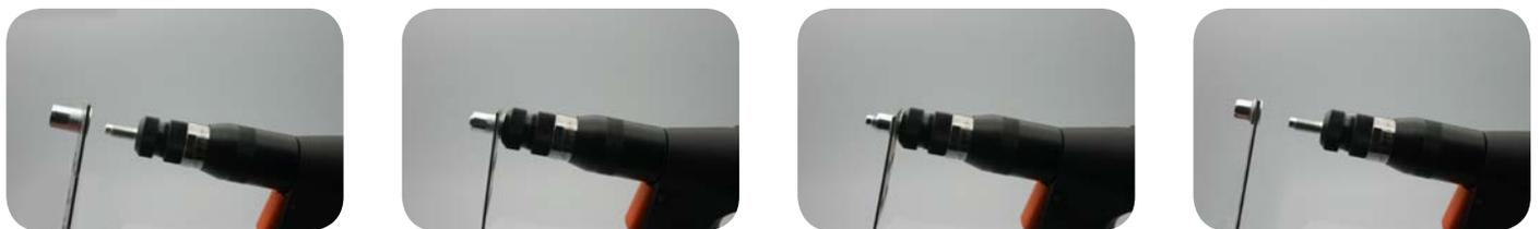
1. Al aproximar y presionar ligeramente la punta del mandril con la tuerca o el tornillo remachable, se introduce automáticamente mediante el giro del mismo.
