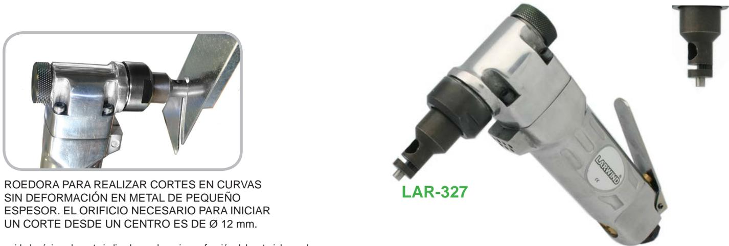
ROEDORA PARA REALIZAR CORTES EN CURVAS SIN DEFORMACIÓN EN METAL DE PEQUEÑO ESPESOR. EL ORIFICIO NECESARIO PARA INICIAR UN CORTE DESDE UN CENTRO ES DE Ø 12 mm.
